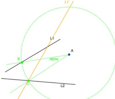
**Lösung.** Wir drehen die Gerade  $L_1$  um den Punkt  $A$  um den Winkel (bzw. das Winkelmaß von)  $\alpha$ . Das Bild davon ist eine Gerade (da die Drehung eine Isometrie ist); um diese Gerade zu bestimmen, können wir zwei Punkte von  $L_1$  auswählen, davon die Bilder bzgl. der Drehung mit Zirkel/Lineal konstruieren, und anschließend die Gerade durch diese Punkte ziehen.
