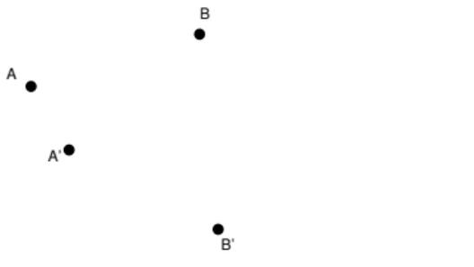
**Lösung.** Man konstruiert die Mittelsenkrechten zu den Strecken  $AA'$  und  $BB'$ . Der Schnittpunkt davon ist der Mittelpunkt der Drehung.
