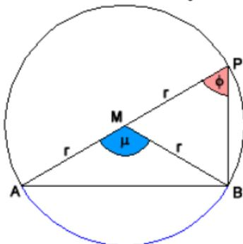
Die beiden Winkel bei  $B$  und  $P$  sind als Basiswinkel in dem gleichschenkligen Dreieck  $MBP$  gleich groß (einfach zu zeigen mit Kongruenzsätzen). Der dritte Winkel des Dreiecks  $MBP$  (mit dem Scheitel  $M$ ) hat die Größe  $180^\circ - \mu$ . Der Satz über die Winkelsumme ergibt folglich  $\phi + \phi + (180^\circ - \mu) = 180^\circ$  und weiter, wie behauptet,  $2\phi = \mu$ .
