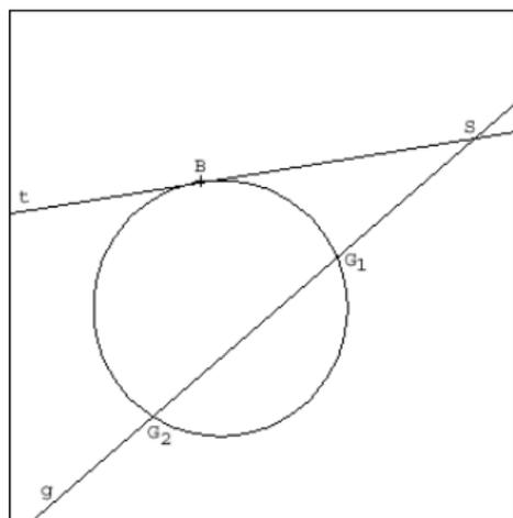
**Folgerung. Sekanten-Tangenten-Satz.** Gegeben sei ein Kreis  $k$  mit einer Sekante  $g$  und einer Tangente  $t$ , die sich in einem Punkt  $S$  außerhalb des Kreises schneiden. Bezeichnet man die Schnittpunkte des Kreises  $k$  mit  $g$  als  $G_1$  beziehungsweise  $G_2$  und den Berührungspunkt der Tangente als  $B$ , so gilt:
