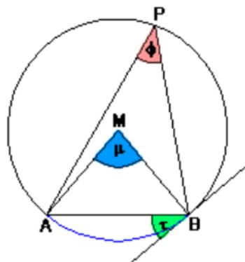
Ist  $M$  der Mittelpunkt des gegebenen Kreisbogens, so bezeichnet man den Winkel  $\angle(A, M, B)$  als den zugehörigen **Mittelpunktswinkel** ( $\mu$  auf dem Bild).
