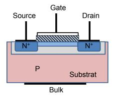
an Ladungsträgern verarmte Schicht um Source, Kanal und Drain (schematisch)
