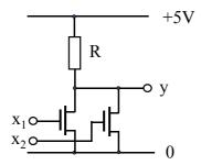
Durch Parallelschalten von 2 Transistoren erhält man ein **NOR**  $x_1 = x_2 = 0 \rightarrow y = 1$ , ansonsten (mind. ein Schalter zu) y = 0
