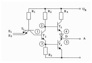
Normal- und Inversbetrieb von T1, Gegentaktendstufe T3, T4, Hubdiode D
