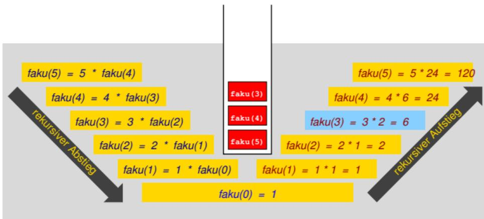
Der **Funktionsaufrufstack** ist ein in seiner Größe variabler Speicherbereich, der nach dem Prinzip „*Last In First Out (LIFO)*“ organisiert ist. Mit *jedem* neuen **Funktionsaufruf** während des rekursiven Abstiegs werden die aktuellen **Argumentwerte** und die **Rücksprungadresse** zur Fortsetzung des Maschinenprogramms nach Aufrufabarbeitung **gespeichert**. Im rekursiven Aufstieg leert sich der Funktionsaufrufstack schrittweise.
